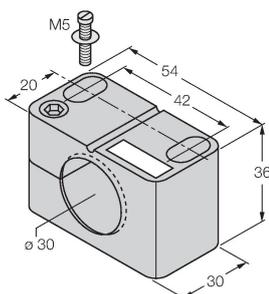
Befestigungsschelle für Gewinderohrsensoren, mit Festanschlag; Werkstoff: PA6
