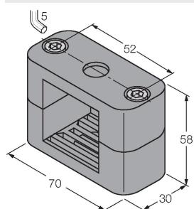
Befestigungsschelle für Quaderbauform 40 x 40 mm;
