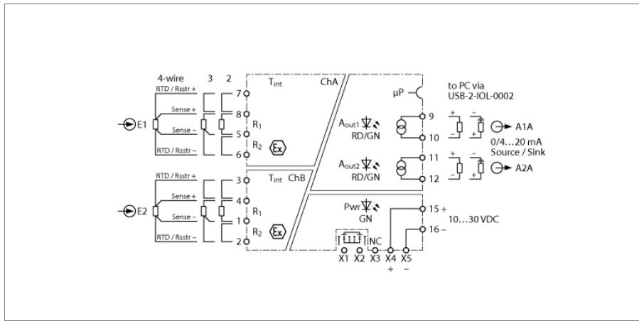
Der 2-kanalige Temperatur-Messverstärker IMX12-TI01-2RTDR-2I-CPR/24VDC verfügt über Eingänge für: RTDs nach IEC 60751, DIN 43760, GOST 6651-94 (2-, 3- und 4-Leiter) sowie Widerstände 0...5 kΩ (2-, 3- und 4-Leiter). Das Gerät kann über eine Power-Bridge versorgt werden, die auch eine Sammelstörmeldung überträgt.
