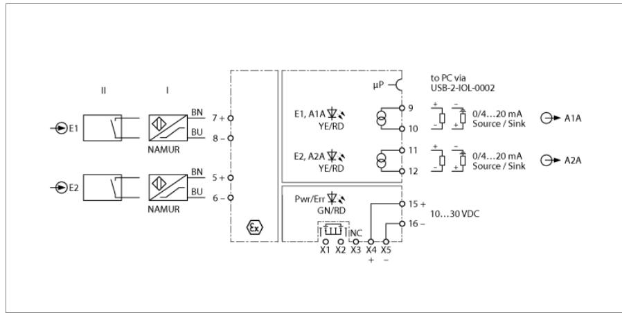
Der Frequenzmessumformer/Puls-Counter IMX12-FI01-2SF-2I-CPR/24VDC/CC ist mit eigensicheren Eingangskreisen ausgestattet und überträgt Frequenzsignale bis 20000 Hz galvanisch getrennt aus dem explosionsgefährdeten Bereich in den sicheren Bereich. Zusätzlich können die Eingangssignale auf Schlupf überwacht werden. Die Geräte sind für den Betrieb in Zone 2 geeignet.
