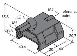
Geführter Positionsgeber für Linearwegsensoren LI-Q25L, wird in die Nut des Sensors geführt
