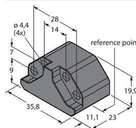
Freier Positionsgeber für Linearwegsensoren LI-Q25L; der Nennabstand zum Sensor beträgt 1,5 mm; Kopplung mit dem Linearwegsensor bei einem Abstand bis zu 5 mm oder einem Querversatz bis 4 mm.
