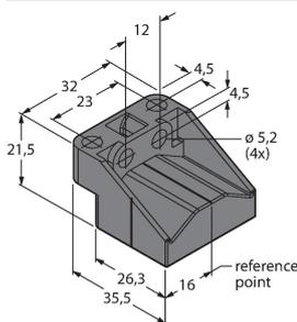
Freier Positionsgeber für Linearwegsensoren Li-Q25L, um 90° versetzt verwendbar; der Nennabstand zum Sensor beträgt 1,5 mm; Kopplung mit dem Linearwegsensor bei einem Abstand bis zu 5 mm oder einem Querversatz bis 4 mm
