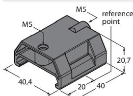
Geführter Positionsgeber für Linearwegsensoren LI-Q25L, ohne Kugelgelenk
