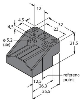
Freier Positionsgeber für Linearwegsensoren LI-Q25L; der Nennabstand zum Sensor beträgt 1,5 mm; Kopplung mit dem Linearwegsensor bei einem Abstand bis zu 5 mm oder einem Querversatz bis 4 mm.
