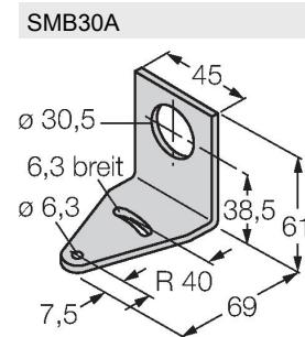
**SMB30A** Montagewinkel, rechtwinklig, Edelstahl, für Sensoren mit 30mm Gewinde
