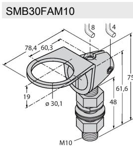
**SMB30FAM10** Montagewinkel, Edelstahl, für 30mm-Gewinde, Gewinde M10 x 1,5
