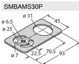
**SMBAMS30P** Montageplatte, Edelstahl, für Sensoren mit 30 mm Gewinde
