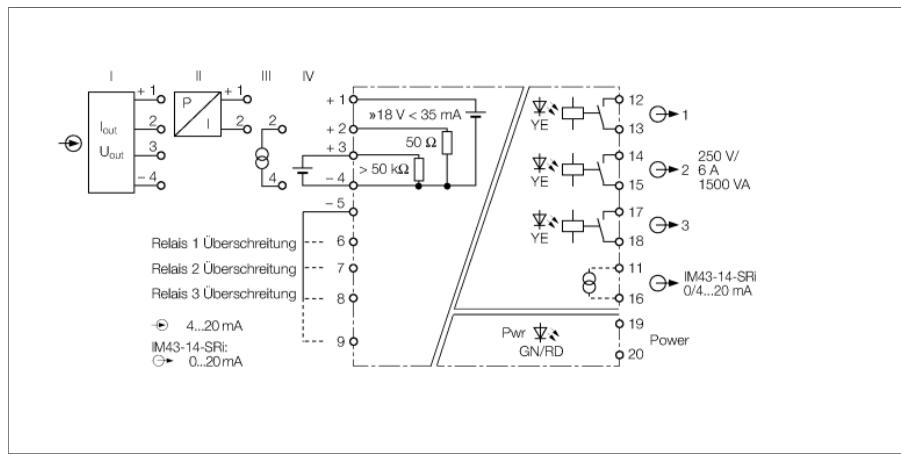
Der 1-kanalige Grenzwertsignalgeber IM43-14-SRI überwacht alternativ Messströme von 0/4...20 mA oder Messspannungen von 0/2...10 V auf Überschreitung und Unterschreitung von Grenzwerten.
