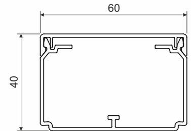
Produktbeschreibung: geeignet zur Verlegung von Niederspannungsleitungen
