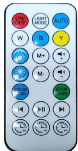
2. [LIGHT MODE]-> Lichtmodus. Wenn Sie diese Taste drücken, werden alle Funktionen eingeschaltet. Wenn Sie die Taste das erste Mal drücken, wird der Sternenhimmel eingeschaltet. Wenn Sie die Taste das zweite Mal drücken, wird die Projektionsfunktion eingeschaltet und wenn Sie die Taste das dritte Mal drücken, werden die oben genannten Funktionen erneut durchlaufen.
