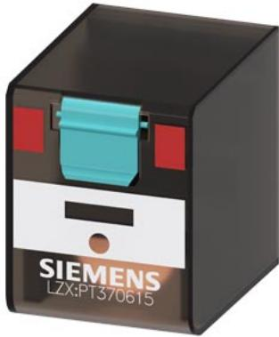
Steckrelais, 3 Wechsler AC 115 V, 10 A, Breite 22,5 mm für LZS-Sockel
