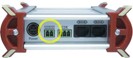
Verwenden Sie für den Anschluss der Kabel, die zum Gleis führen, das mitgelieferte 2-polige Steckerteil. Stecken Sie die Anschlusskabel in das Steckerteil, schrauben Sie sie fest und stecken Sie das Steckerteil dann auf die Buchse auf der Rückseite des Boosters und zwar so, dass die Schrauben nach oben zeigen.
