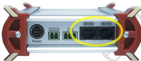
Verbinden Sie einen der beiden BiDiB-Anschlüsse des B-6 über ein RJ 45-Kabel mit dem BiDiB-PC-Interface. Die beiden RJ 45-Buchsen der BiDiB-Schnittstelle sind parallel geschaltet, Sie können daher eine beliebige Buchse verwenden.
