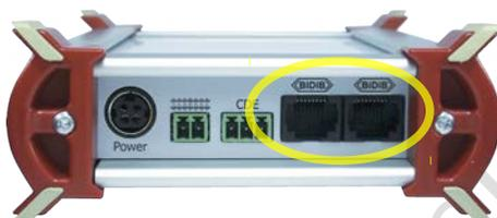
Verbinden Sie einen der beiden BiDiB-Anschlüsse des B-6 über ein RJ 45-Kabel mit der BiDiB-Schnittstelle Ihrer Zentrale. Die beiden RJ 45-Buchsen der BiDiB-Schnittstelle sind parallel geschaltet, Sie können daher eine beliebige Buchse verwenden.
