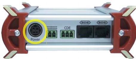
Stecken Sie den 4-poligen Gerätestecker des Netzteil-Anschlusskabels in die Buchse "Power" auf der Rückseite des B-6 und zwar so, dass der flache Teil des Steckers nach oben zeigt.
