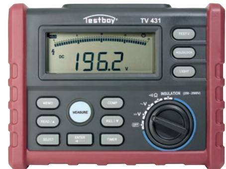
Das digitale Isolationsmessgerät Testboy TV 431 ist für eine einfache Überprüfung des Isolationswiderstandes von Geräten, elektrischen Anlagen und Schaltungen konzipiert. Für besonders aussagekräftige Messergebnisse stehen vier wählbare Prüfspannungen zur Verfügung – und das bis 2500 V. Der Einsatzbereich wird durch die Möglichkeit, Wechsel- und Gleichspannung sowie Durchgangs- und Widerstandsmessungen durchzuführen, erheblich erweitert.
