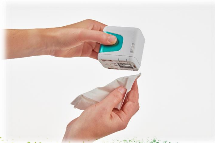
Abb. 18: Druckkopf manuell reinigen
