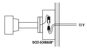
\*DCST-SCHRAUB (DC-Stecker mit Schraubklemmen) ist im Lieferumfang des Strahlers enthalten
