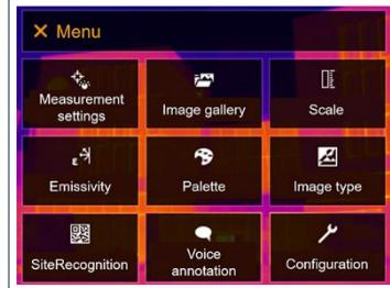
2 Konfiguration [Configuration] auswählen (Joystick oder Touchscreen).
