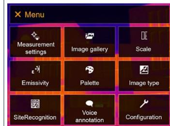
1.2 | **Konfiguration [Configuration]** auswählen (Joystick oder Touchscreen).
