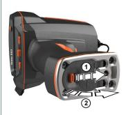
Akku vollständig in den Akku-Schacht einschieben, bis dieser bündig mit der Unterseite des Handgriffs abschließt.
