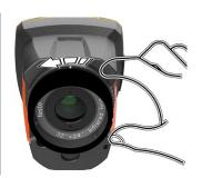
Objektiv bis zum Anschlag gegen den Uhrzeigersinn drehen.
