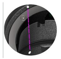
3 Objektivfixierring bis zum Anschlag im Uhrzeigersinn drehen.
