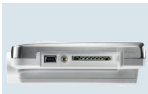
Seitlicher Anschluss von Mini-USB-Kabel und SD-Karte
