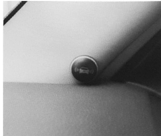
6.8.2 Der Summer wird in der Hauptfahrermittelkonsole angebracht, um eine wahrnehmbare Tonausgabe sicherzustellen. Andere Verdrahtungen können dem Installationsdiagramm entnommen werden.
