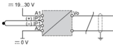
Die Eingangs-, Ausgangs- und Spannungsversorgungsleitungen müssen separat von den Netzkabeln verlegt werden, um unerwünschte Auswirkungen aufgrund induzierter Störspannungen zu vermeiden.
