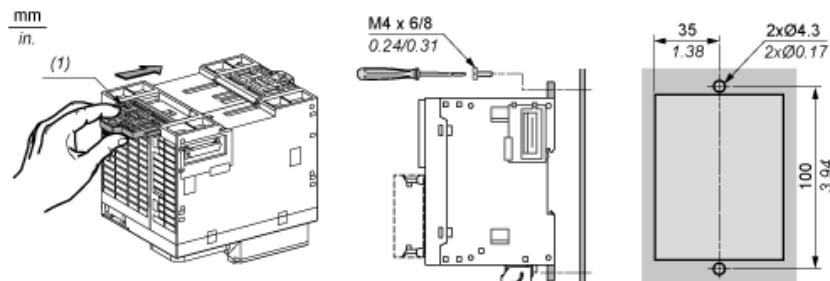
(1) Montieren eines Montagebandes
