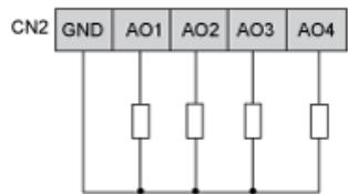
AO3, AO4 können als PWM-Generator eingesetzt werden, bis 2 kHz.
