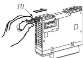
(1) Montieren eines Montagebandes
