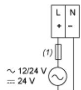
(1) Sicherung Typ T (Steuerung: 1,25 A, Erweiterung: 1 A)
