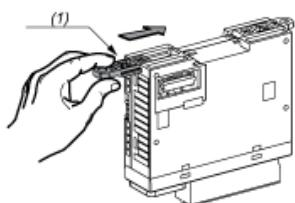
(1) Montieren eines Montagebandes
