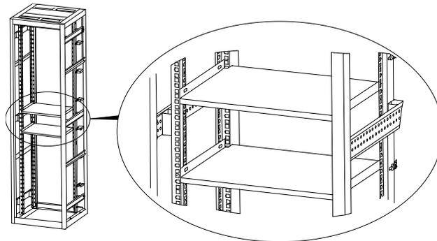
Beachten Sie zur Installation von USV und Batterie in einem 19-Zoll-Gestell-Gehäuse das nachstehende Diagramm. Heben Sie das USV-Modul an und schieben Sie es in das Gestell. Sichern Sie das USV-Modul über seine Montagehalterungen mit Schrauben, Muttern und Unterlegscheiben (nicht im Lieferumfang enthalten) in den Schienen am Gestell.
