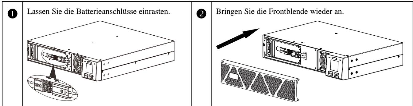
Schließen Sie die Batterie bei Tower-Modellen an, indem Sie den Batteriegriff nach oben ziehen und dann in das Gerät drücken.
