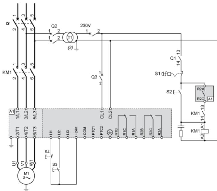
230-VAC-Steuerung, Logikeingänge (LI) 24 VDC, 2-Draht-Steuerung, freier Auslauf
