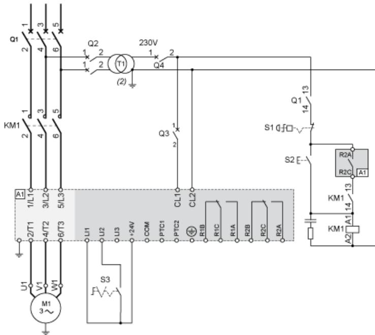
Anschluss in die Dreieckwicklung des Motors, mit jeder einzelnen Wicklung in Reihe
