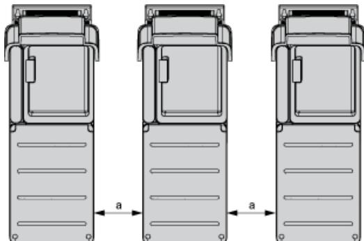
Baugrößen 1, 2, 3, 3S und 5S:  $a \geq 100 \text{ mm (3,9 in.)}$
