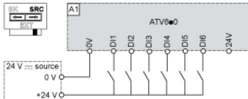
Schalter in Stellung „SK (Senke)“ bei Verwendung der Ausgangsversorgung für die Digitaleingänge
