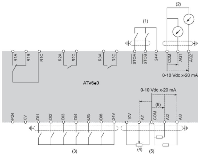
(1) Safe Torque Off: sicher abgeschaltetes Drehmoment
