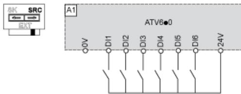
Schalter in Stellung „SRC (Quelle)“ und Verwendung einer externen Versorgung für die Digitaleingänge
