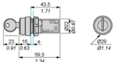
e Stärke der Trägerplatte: 1 bis 6 mm / 0.4 bis 0.24 in. (Metall), 2 bis 6 mm / 0.8 bis 0.24 in. (Kunststoff)
