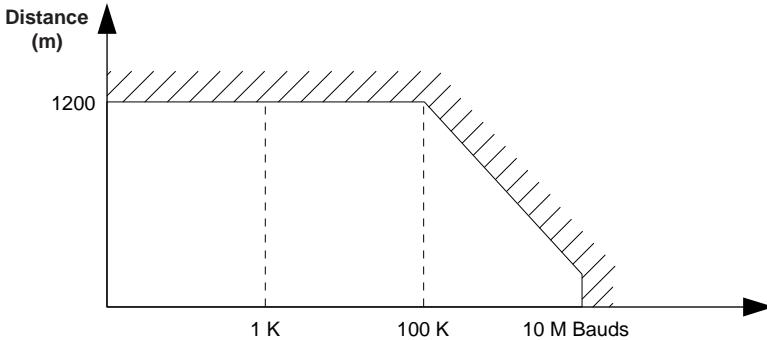
Câblage = 2 paires torsadées blindées section minimale 0,6 mm<sup>2</sup> AWG22 (plus OV)
