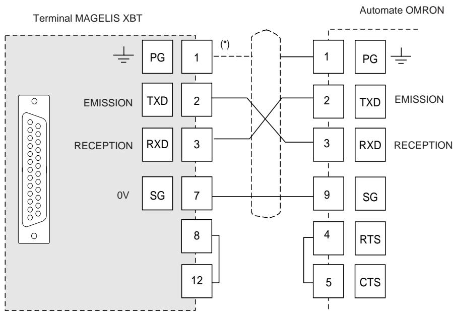
\* Le raccordement du blindage aux deux extrémités dépend des contraintes électriques liées à l'installation.
