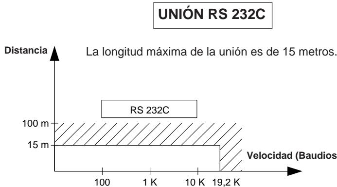
Cableado = 3 hilos blindados (sección mínima 0,6 mm<sup>2</sup> AWG22)
