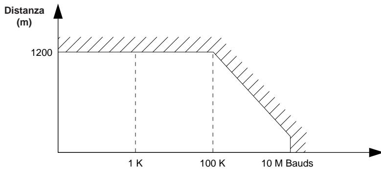
Cablaggio = 2 doppini intrecciati schermati sezione minima 0,6 mm<sup>2</sup> AWG22 (più OV)
