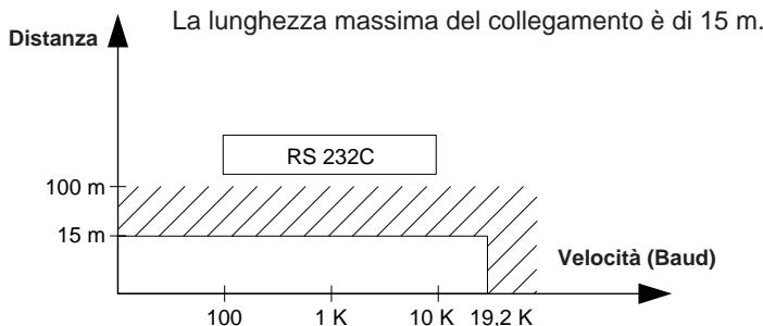
Cablaggio = 3 fili schermati (sezione minima 0,6 mm<sup>2</sup> AWG22)
