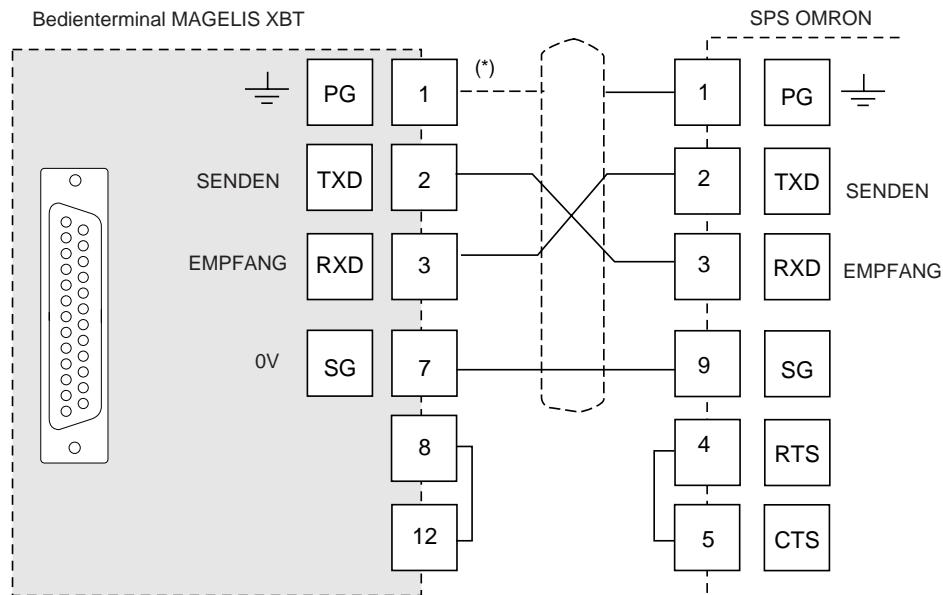
\* Der Anschluß der Abschirmung an beiden Kabelenden ist von den elektrischen Betriebsbedingungen abhängig.
