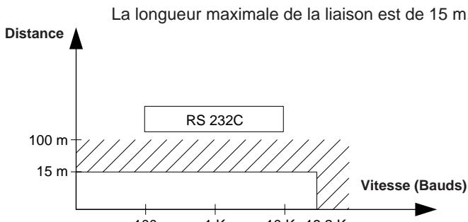
Câblage = 3 fils blindés (section minimale 0,6 mm<sup>2</sup> AWG22)
