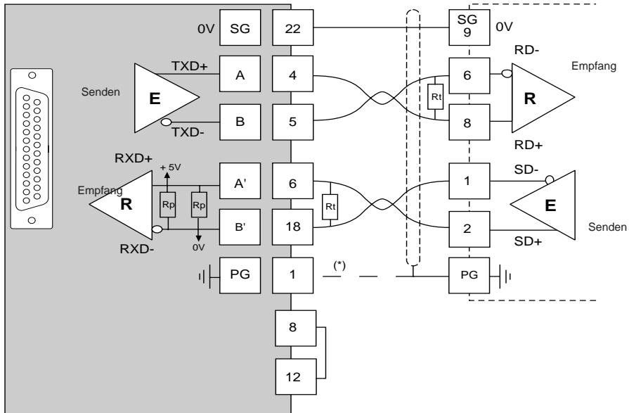
\* Der Anschluß der Abschirmung an beiden Kabelenden ist von den elektrischen Betriebsbedingungen abhängig.
