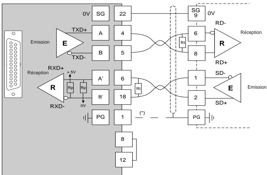
\* Le raccordement du blindage aux deux extrémités dépend des contraintes électriques liées à l'installation.
