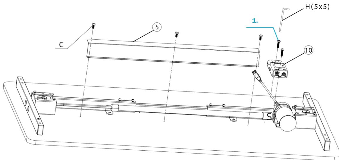
Abdeckung ⑤ mit Schrauben (C) befestigen, um die Federstange abzudecken. Griff ⑩ seitlich am Motor (siehe Abbildung) einhängen und mit Schrauben (ST4.2x19, Montagezubehör zum Bedienelement) befestigen.
