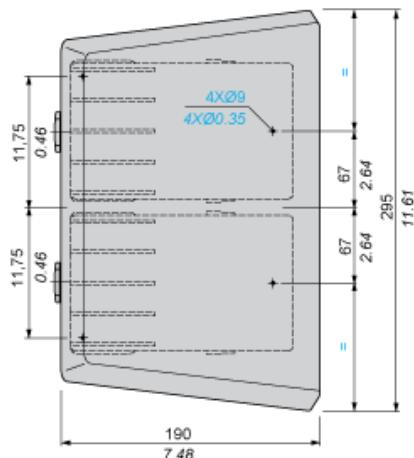
(1) 2 Gewindedurchführungen für Kabelverschraubung Nr. 16 (Pg 16). Für ISO M20 Adapter DE9RA620 verwenden.
