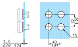
(1) Ø 22,5 mm empfohlen ( $\varnothing 22,3 \text{ mm}^{+0,4}$ ) / Ø 0.89 in. empfohlen ( $\varnothing 0.88 \text{ mm}^{+0,016}$ )
