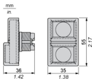
Schalttafelausschnitte für Drucktaster, Schalter und Meldeleuchten (fertige Bohrungen, installationsbereit)
