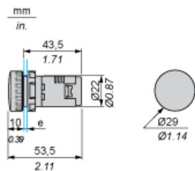
e Stärke der Trägerplatte: 1 bis 6 mm / 0.4 bis 0.24 in. (Metall), 2 bis 6 mm / 0.8 bis 0.24 in. (Kunststoff)
