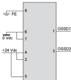
Mit Rückkopplungsschleife für externe Geräteüberwachung (EDM: External Device Monitoring)
