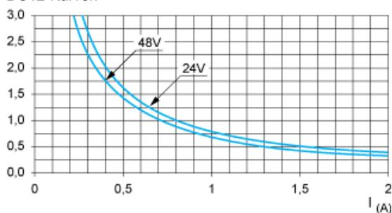
DC12Steuerung von ohmschen Lasten und Halbleiterlasten mit Trennung durch Optokoppler  $I/R \leq 1 \text{ ms}$ .
