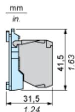
mit ZB4BZ009 Befestigungsflansch
