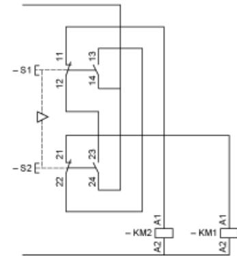
Steuerung eines Motors mit zwei Drehzahlen und zwei Drehrichtungen
