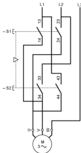
In Verbindung mit 3-poligem Isolationsblock XACS399 oder XACS3991, gezeigt in der nicht betriebenen Position (Station wartet auf „Versorgung“), ausgestattet mit Not-Aus-Schalter mit Auslöserbetätigung, Schlüsselentriegelung und Einrastfunktion.
