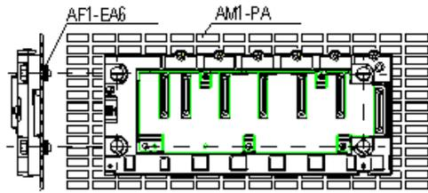
Sichern Sie das Rack mit vier Schrauben M4, M5, M6 oder UNC Nr. 6.
