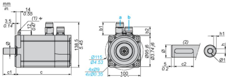
a: Spannungsversorgung für Servomotorbremse
