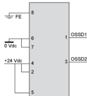
Mit Rückkopplungsschleife für externe Geräteüberwachung (EDM: External Device Monitoring)
