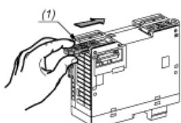
(1) Montieren eines Montagebandes
