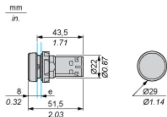
e Stärke der Trägerplatte: 1 bis 6 mm / 0.4 bis 0.24 in. (Metall), 2 bis 6 mm / 0.8 bis 0.24 in. (Kunststoff)
