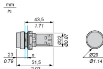
e Stärke der Trägerplatte: 1 bis 6 mm / 0.4 bis 0.24 in. (Metall), 2 bis 6 mm / 0.8 bis 0.24 in. (Kunststoff)
