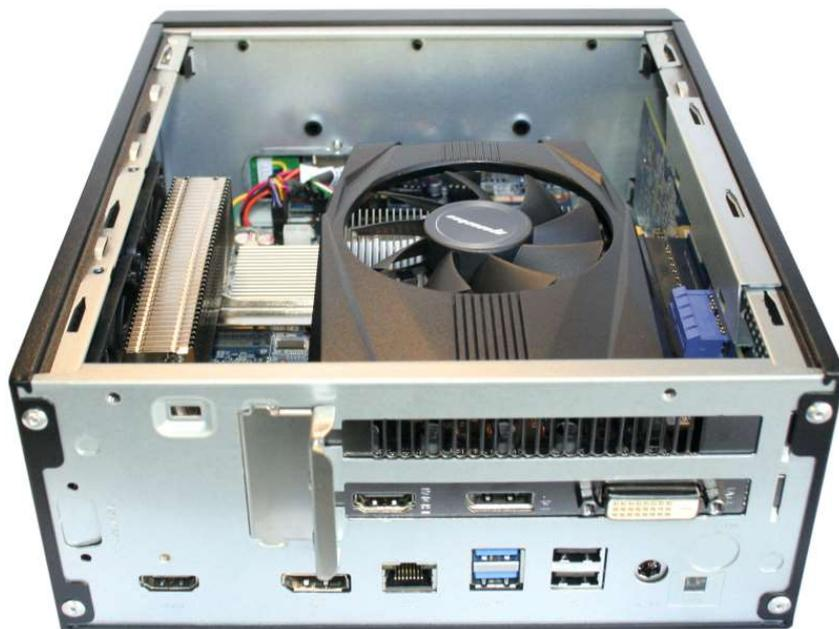
Trotz der geringen Gehäuseabmessungen verfügt der Shuttle XPC slim Barebone XH510G2 über einen vollwertigen PCI-Express-X16-Steckplatz für Dual-Slot-Erweiterungskarten mit bis zu 208 mm Länge, 120 mm Höhe und 45 mm Breite und max. 75W Verlustleistung. Gleichzeitig werden leistungsstarke PC-Komponenten unterstützt, wie zum Beispiel ein Intel Core i9 Prozessor oder 64 GB RAM. Dies eröffnet zahlreiche Einsatzmöglichkeiten, für die man bisher oftmals einen wesentlich größeren PC benötigte.
