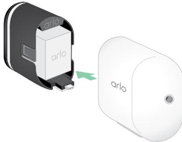
3. Entfernen Sie den Akku, indem Sie an ihm ziehen, bis er aus der Kamera gleitet.
