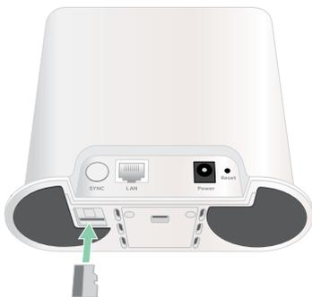
2. Drücken Sie auf den Rand der microSD-Karte, bis sie vollständig in den Steckplatz eingesetzt ist.
