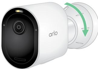
**Hinweis:** Um Ihre Kamera aus dem Gehäuse zu lösen, stecken Sie den Sicherheitsschlüssel in das Sicherheitsschlüsselloch und drehen Sie ihn im Uhrzeigersinn.
