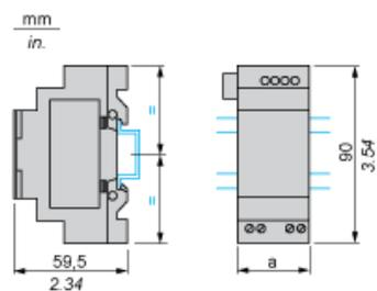
Schraubbefestigung (versenkbare Befestigungslaschen)
