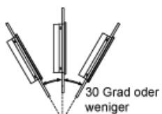
Bei der Montage einer Schaltafel in schräger Position mit einer Neigung von mehr als 30° darf die Umgebungstemperatur 40°C (104°F) nicht übersteigen. Gegebenenfalls müssen Sie eine Gebläseluftkühlung (Ventilator, Klimaanlage) einsetzen, damit eine Umgebungsarbeitstemperatur von höchstens 40°C (104 F) gewährleistet ist.
