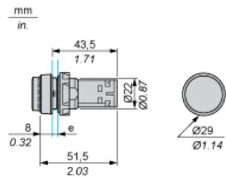
e Stärke der Trägerplatte: 1 bis 6 mm / 0.4 bis 0.24 in. (Metall), 2 bis 6 mm / 0.8 bis 0.24 in. (Kunststoff)
